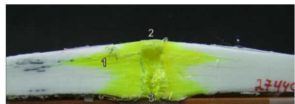
איור 3 – פלטת Dyneema לאחר ניסוי ירי, כאשר 3 מנגנוני הכשל העיקריים מסומנים באזורים האופייניים להם
